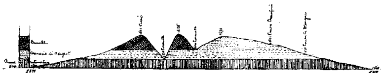
Sezione indicante la relazione fra rocce metamorfiche, arenarie e basalti in un taglio in direzione N.E.-S.O. nei pressi di Chenafenà.
